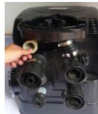
3. Dévisser le bouchon de dégonflage et retirer la vis ou le lien sur le bouchon.
