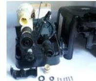
7. Retirer les 6 vis du conduit puis effectuer son remplacement et suivre les étapes en sens inverse pour le remontage du bloc technique.
