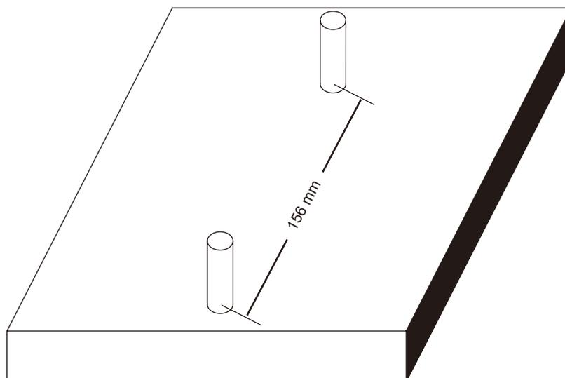
1. Les orifices de fixation ont un diamètre de 6,4 mm et sont écartés de 156 mm.
