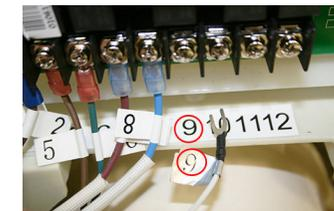
Suivant le modèle de votre bloc technique et suite à une évolution de la carte électronique, il est possible que la cosse bleue présente sur votre bloc technique ne soit pas à brancher sur la nouvelle carte reçue.
