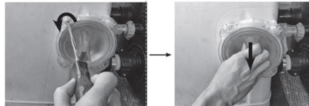
2. Débrancher le câble de la cellule électrolytique. Dévisser l'écrou de la cellule électrolytique dans le sens inverse des aiguilles d'une montre, à l'aide de la clef fournie avec le SPA
