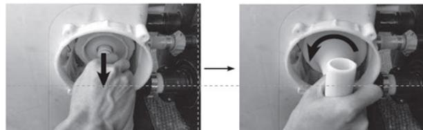
3. Sorter la cellule électrolytique et la placer dans un récipient. Verser du vinaigre blanc dans le récipient à hauteur des plaques de titane et laisser
