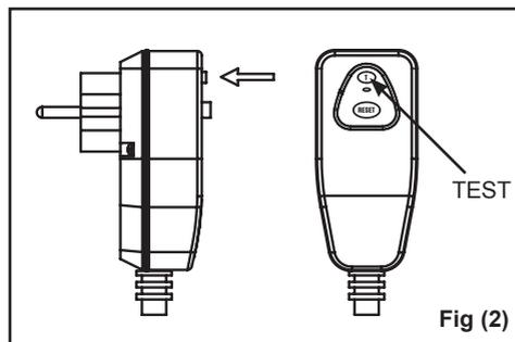
3. Pressez le bouton RESET pour l'utiliser. Ne l'utilisez pas si le test a échoué. Contactez un électricien qualifié pour déterminer les causes de l'échec.
