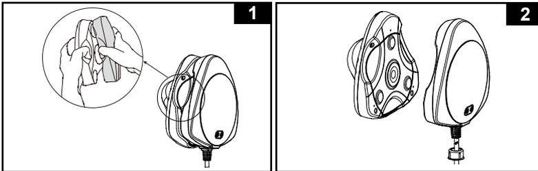
2. Placez l'émetteur (2) à l'extérieur de la piscine et la lampe (1) à l'intérieur, dans l'eau. Assurez-vous que l'émetteur soit correctement aligné avec les pôles magnétiques de la lampe. **Voir dessin (3).**
