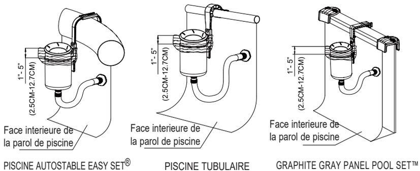
**IMPORTANT** : Le skimmer doit être en position verticale en permanence pour que le haut du couvercle flottant soit parallèle à la surface de l'eau pour la circulation de l'eau.
