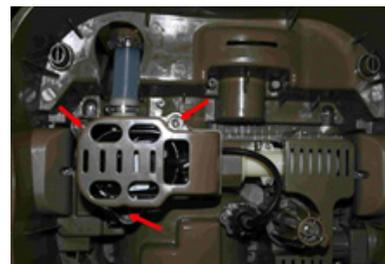
4. Dévisser l'embout de serrage noir (1) et débrancher la prise d'alimentation du moteur puis dévisser la bague de serrage à la sortie du moteur (2), retirer le moteur.
