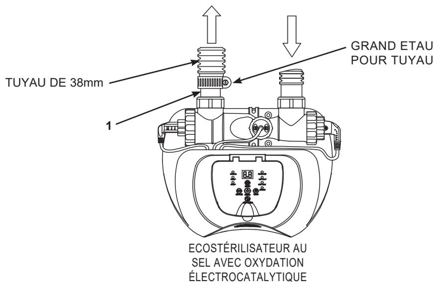
1. Raccordez l'adaptateur A (1) à l'écrou de sortie de la cellule électrolytique (3). Serrez fort.
