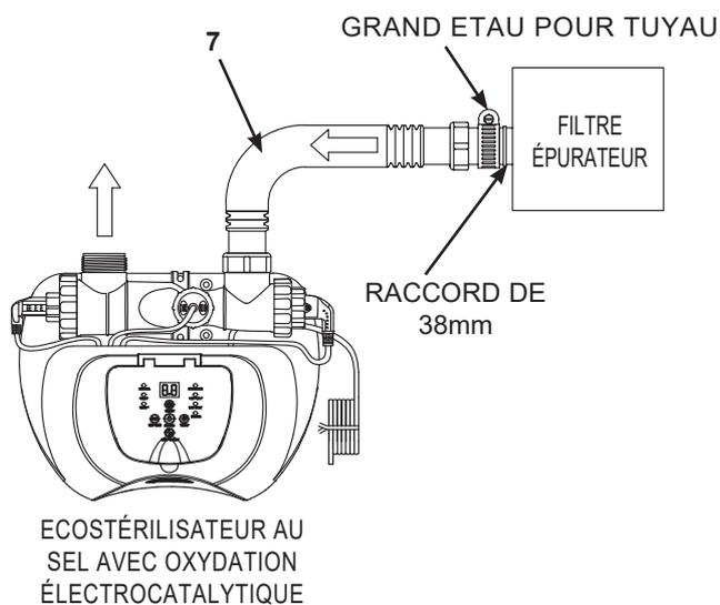
1. Raccordez le tuyau de connexion (7) à la connexion de sortie du filtre de la pompe avec un grand étau pour tuyau. Serrez fort.
