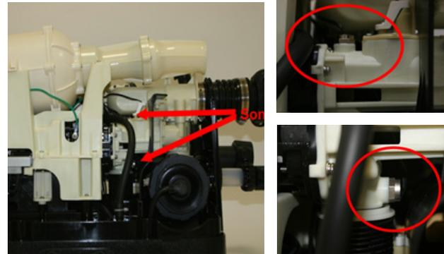
2. Retirer le joint de la sonde puis le placer sur la nouvelle sonde et effectuer les étapes en sens inverse
