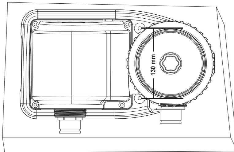
1. Les orifices de fixation ont un diamètre de 6,4 mm et sont écartés de 130 mm.
